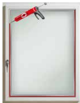
Szczelina pomiędzy szybą a skrzydłem zostaje wypełniona klejem na całym obwodzie
