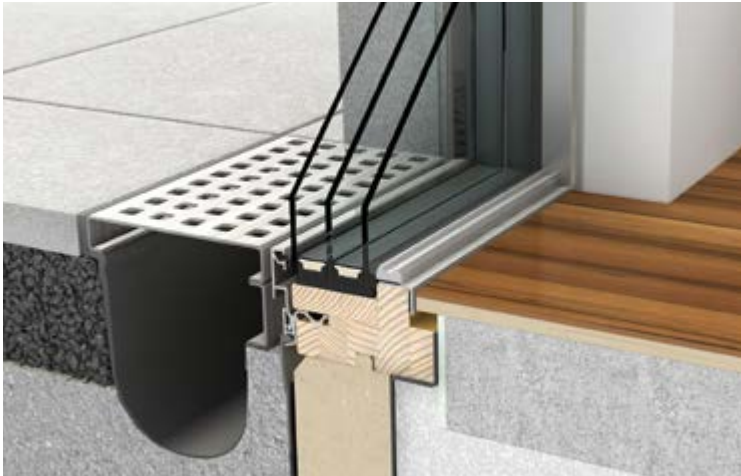
Brak widocznych ościeżnic i montaż optymalny pod względem technicznym
